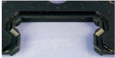
Dichtlippe ist nicht beschädigt.
