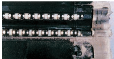
Wageninneres; keine Fremdpartikel an den Wälzkörpern
