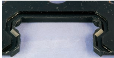
Dichtlippe ist nicht beschädigt.
