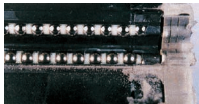
Wageninneres; keine Fremdpartikel an den Wälzkörpern
