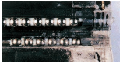
Große Menge an Fremdpartikeln sind ins Wageninnere gelangt
