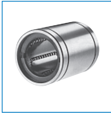
KBB...G mit Kunststoffkäfig UU = Beidseitig abgedichtet Dünnschicht Korrosionsschutz auf Ni-Basis
