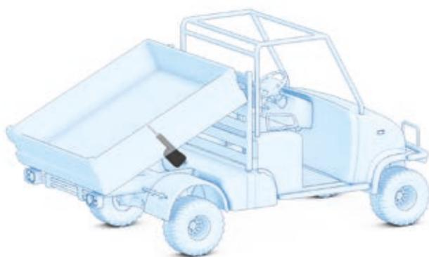
Garten-, Baustellen- und Versorgungsfahrzeuge müssen sowohl robust als auch effizient steuerbar sein. Der Schutz gegen Umgebungseinflüsse (IP69K), hohe Tragzahlen und die CAN-Bus-Kommunikation (J1939) stehen für diese Leistungsmerkmale.
