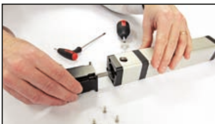
Motorwelle in Kupplung einführen
