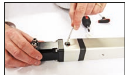
Motorkupplungsschrauben anziehen und Dichtstopfen einsetzen
