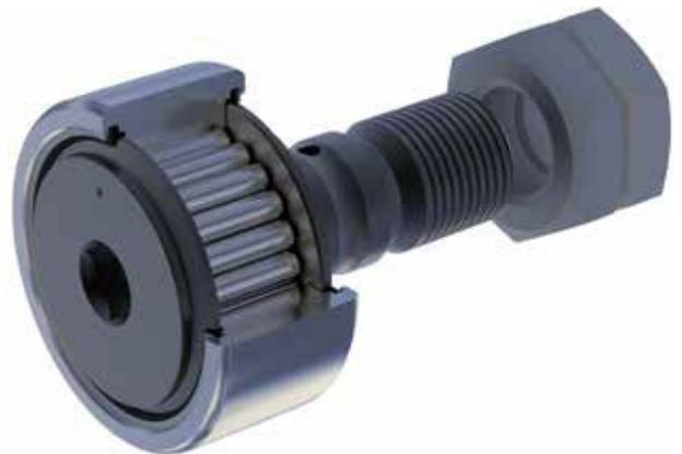
Es handelt sich um die klassische Kurvenrolle mit Bolzen von Nadella, die durch die Verlängerung der Tiefe des Einstellsechskants an jedem Ende und für alle Abmessungen aktualisiert wurde. Das optimierte Profil an der Lauffläche des Außenrings wurde ebenfalls eingeführt (Einzelheiten siehe Seite 57).
